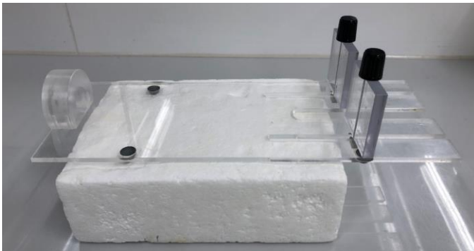
Vorrichtung zum Legen eines Venflon und von Kathetern in die anästhesierte Ratte
